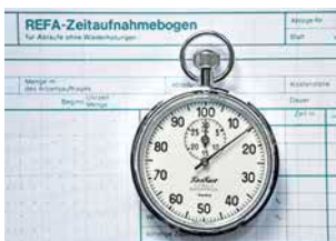
1: Traditionelle mechanische REFA-Stoppuhr und REFA-Zeitaufnahmebogen
